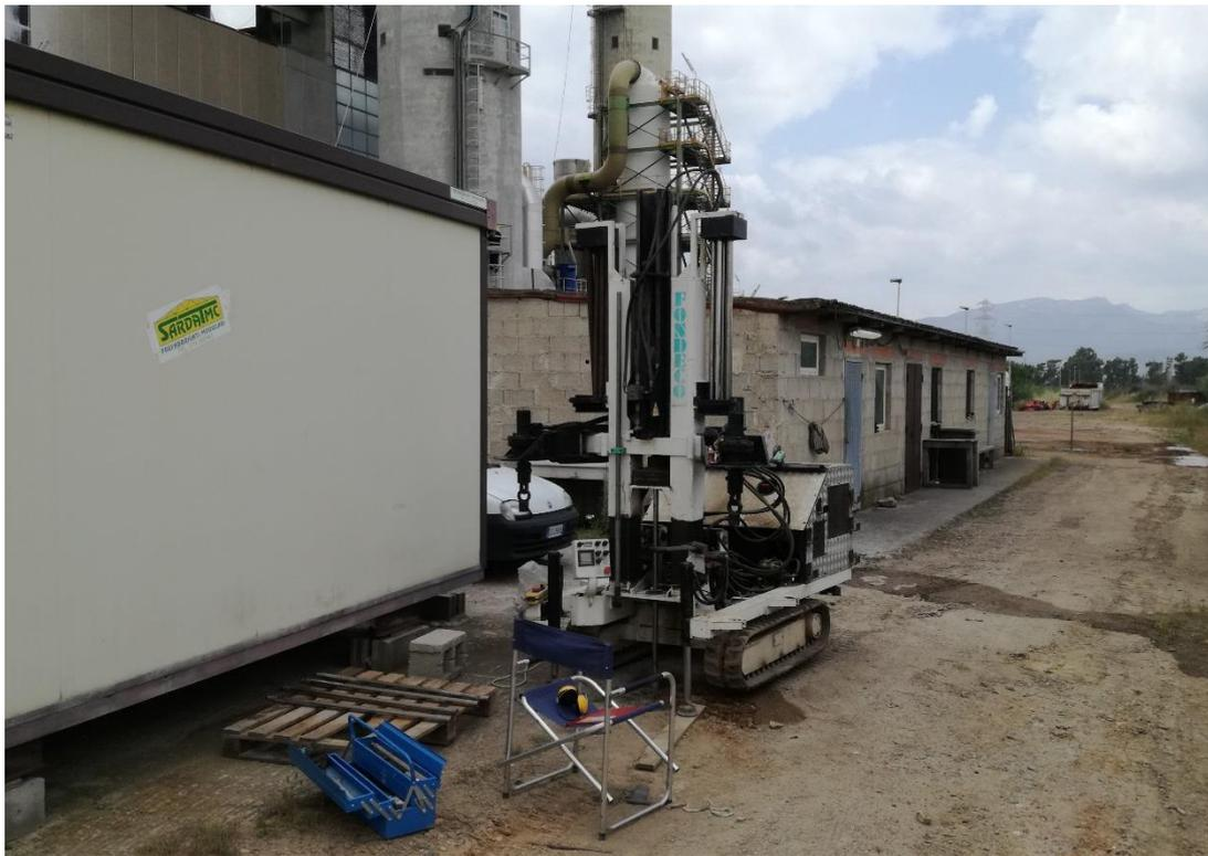
Posizionamento prova DPSH 2
