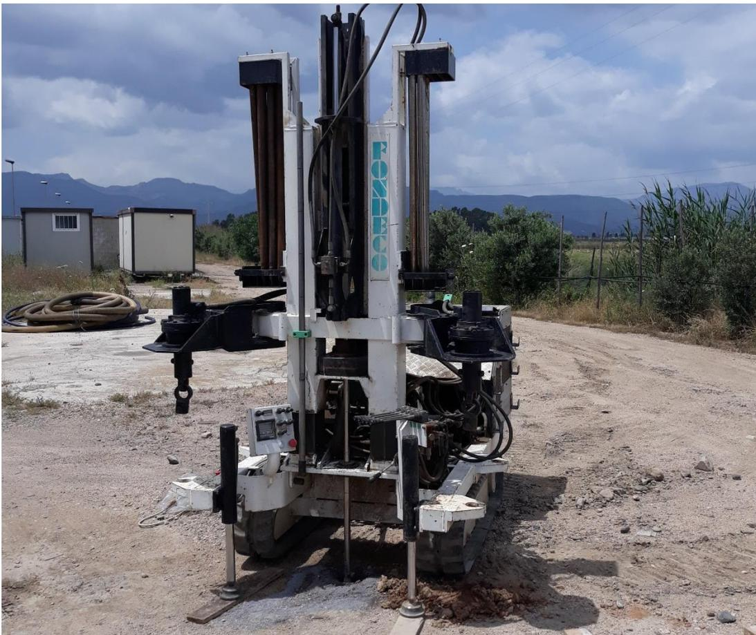
Posizionamento prova DPSH 3
