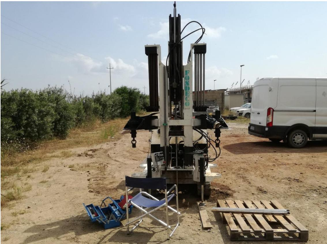
Posizionamento prova DPSH 1
