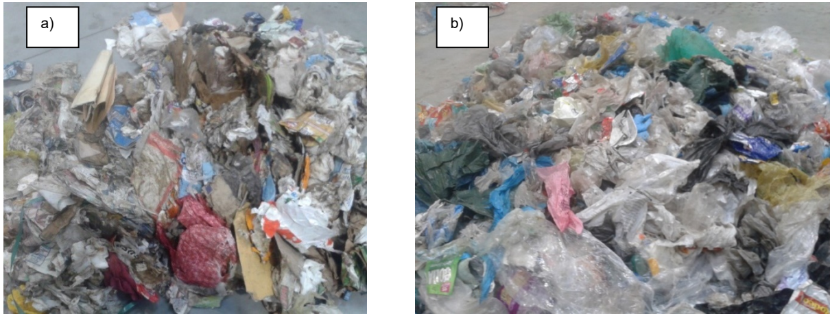
Figura 3.44 - Immagini fotografiche che documentano la qualità dei materiali ottenuti a seguito della separazione manuale dal secco residuo: a) carta; b) plastica.
